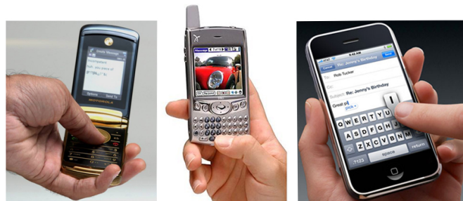
Slika 4 Problematika unosa informacija putem malih tipkovnica (s lijeva na desno): numerička tastatura, puna QWERTY tastatura i virtualna izvedba tipkovnice na zaslonu osjetljivom na dodir
