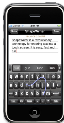
Slika 5 ShapeWriter metoda za unos teksta (riječi) koristi jednostavne geste (poteze prstom) na zaslonu osjetljivom na dodir
